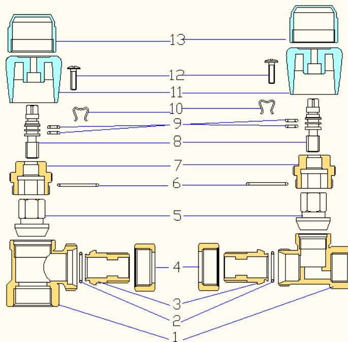
Корпус клапана 1 изготовлен из латуни CW617N методом горячей штамповки. К корпусу через уплотнительные прокладки из EPDM 2 6 присоединена латунная муфта вентильного узла 7 и патрубок полусегона 3. Патрубок полусегона крепится к корпусу с помощью накидной гайки 4.
