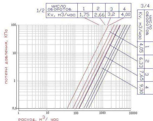
\*Графики приведены при подаче теплоносителя под золотник. При обратной подаче теплоносителя к Kv применяется коэффициент 0,88.
