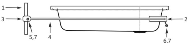
Комплектность электропотенциала (№ позиции, наименование, количество): 3- Проводник длиной 200 мм (хомут), 1 шт.; 4- Проводник длиной 1400 мм, 1 шт.; 5- Болт М6х30, 1 шт.; 6- Болт М6х16, 1 шт., 7- Гайка М6, 2 шт.
